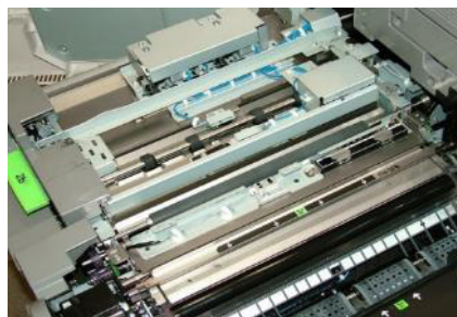
Le transport d'alignement permet de réaliser un cadrage très précis du papier (+/- 0,5 mm).
