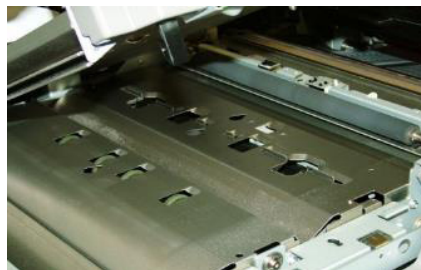
Le dispositif de cadrage effectue le déuilage du papier puis s'abaisse, laissant la feuille avancer jusqu'au capteur d'image par contact pour un réglage supplémentaire.
