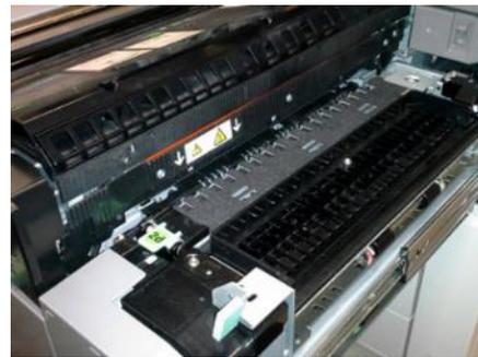
Eliminador de curvatura do mecanismo de impressão
