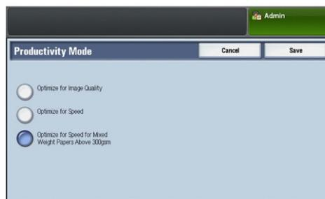
A Versant® 3100 conta com uma terceira configuração: Otimize a velocidade para papéis de gramatura mista de até 300 g/m<sup>2</sup>.
